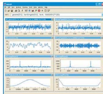
ヘシフトされます。ベースバンド処理された信号、フィルターをかけた信号、それと元の高い周波数ヘシフトされた信号は、それぞれWindows 2、3と4で示されます。ウインドウ5は、最初のノイズが加算されたノイズを含む信号、そしてWindow 8は、フィルターをかけたきれいな信号のスペクトルを示します。これらの2つの信号を比較することによって、多くのノイズが明らかにフィルターをかけることによって除去されたが簡単に分かります。
