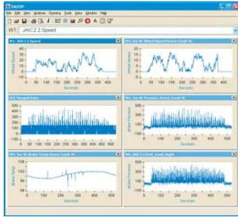
REPLACEコマンドが、圧力レンジの外側のデータを0にするのに使われます。これにより、温度データが取り除かれます。その結果、ブレーキの圧力データは、ウィンドウ4に表示されます。また、データをCLIPおよびREPLACEするためのマクロがウィンドウ3に適用されます。その結果、温度データが抽出され、ウィンドウ5に表示されます。
